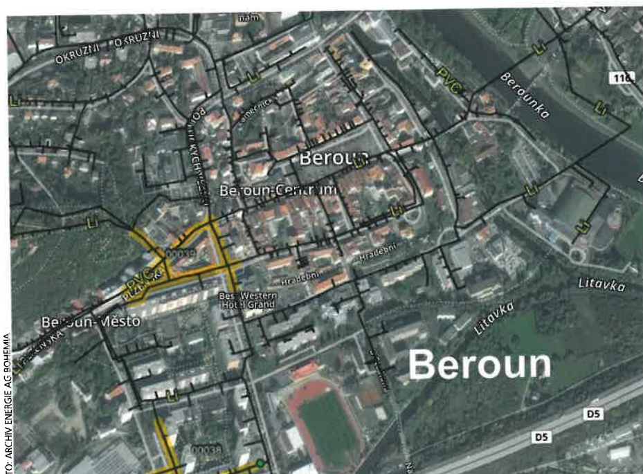
Výstupem analýzy je vyznačení míst s pravděpodobným únikem (rádius 100 m). Barevná škála navíc určuje pravděpodobnost poruchy. Mapa je k dispozici na webu a v mobilní aplikaci, takže ji lze použít i v terénu
